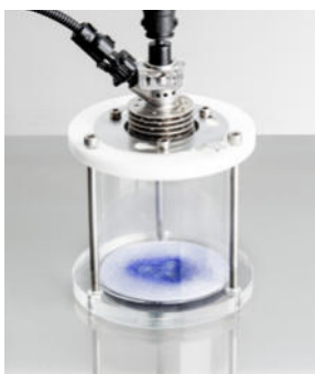
Sichtprüfung Sprühbild & Bestimmung Einspritzmenge
